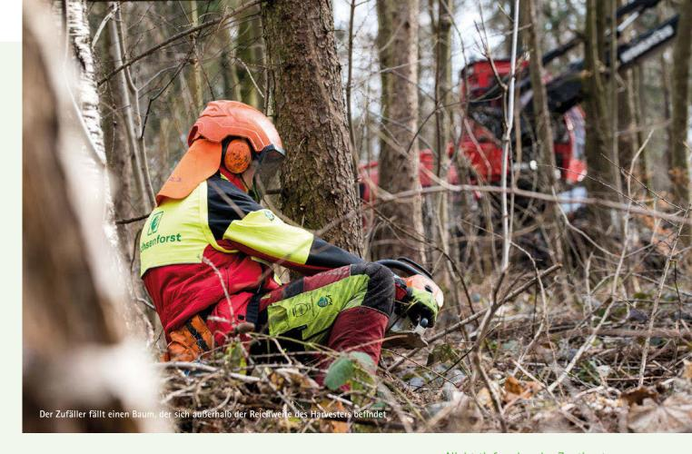
die Forstmaschinen von den Rückegassen zu beiden Seiten in das Waldstück hineingreifen." Mit den größeren Gassenabständen heute schonen sie den Waldboden effektiver. Doch bei der Holzernte müssen sie sich dafür etwas einfallen lassen. Sie blickt zum Waldarbeiter hinüber. "Das ist ein Zufäller", sagt sie. "Er fällt den Baum in Richtung des Harvesters. Der kann den Stamm dann greifen, ohne in den Wald hineinfahren zu müssen."
